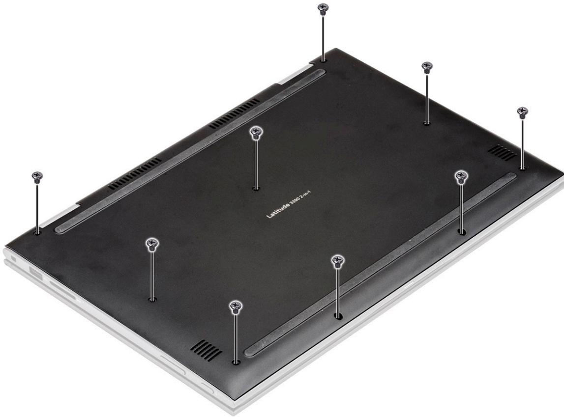
4. Con un punzón de plástico, haga palanca en la cubierta de la base desde los bordes del chasis de la laptop [1].
